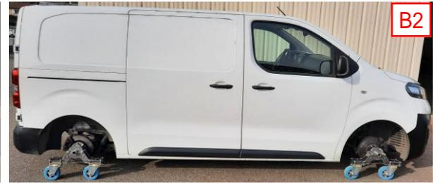
REMARQUE : La composition 4 Blocs Unidirectionnels existe, mais ce n'est pas la plus pertinente pour les déplacements latéraux
